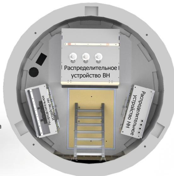
Распределительное устройство ВН типа ТРМ
